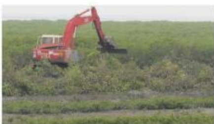
為提高小怪手作業效率加裝寬耙
