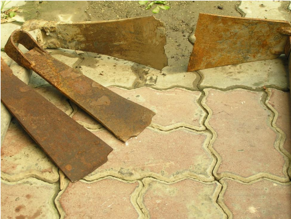
圖二十三：長刀型鋤頭因剷除大植株造成刃部缺裂。
