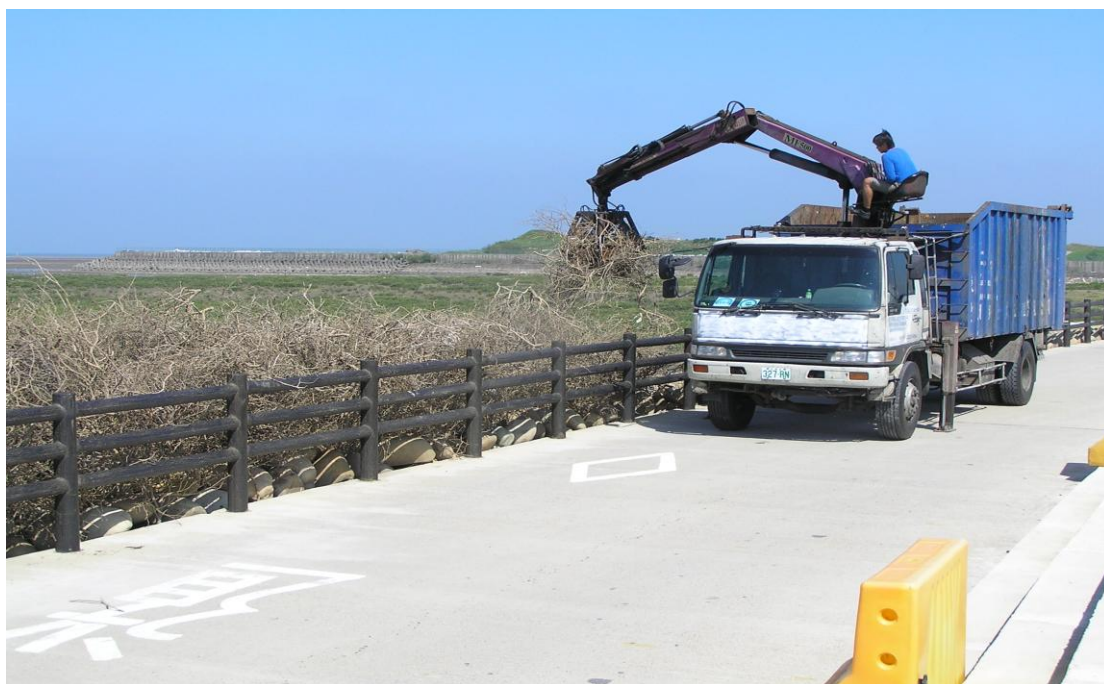
圖八：貨車停於自行車道上，以車上配備之抓斗將人力清運至岸邊的枝幹抓至貨車上，本次共清運 20 車次，約 40 噸紅樹林枝幹。
