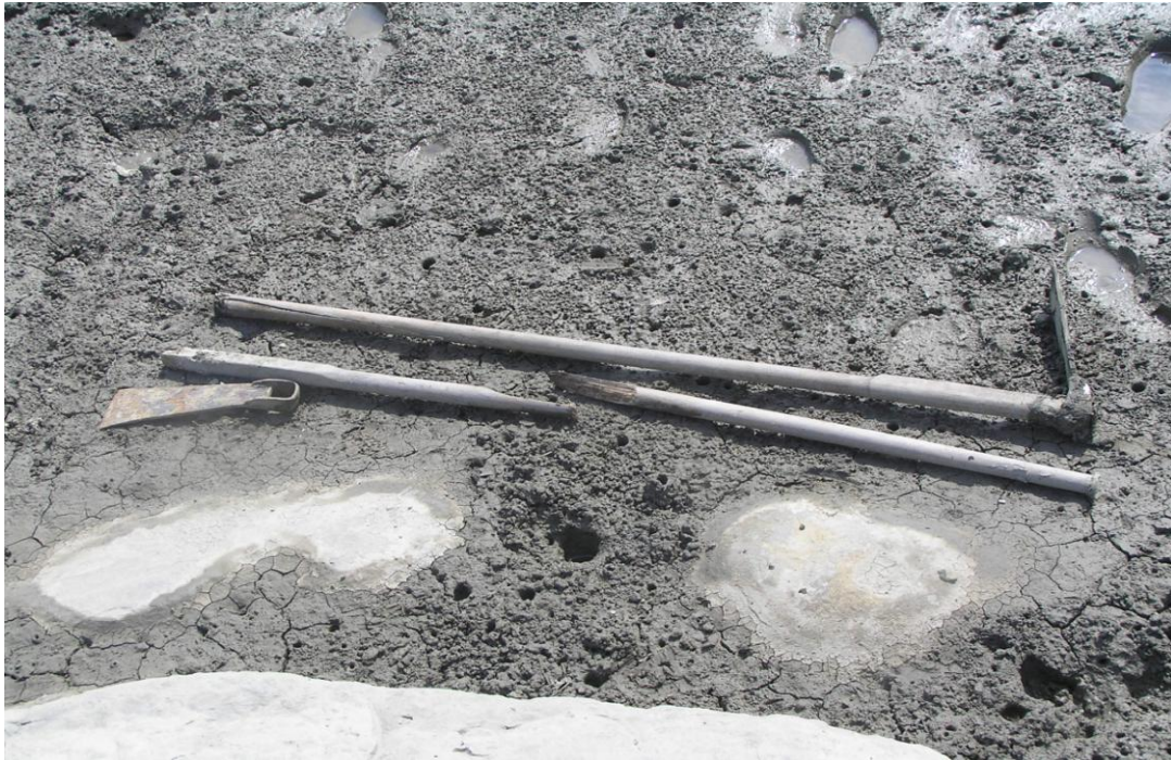
圖三：長刃型鋤頭因清除工作而造成木柄斷裂及鋤頭脫落
