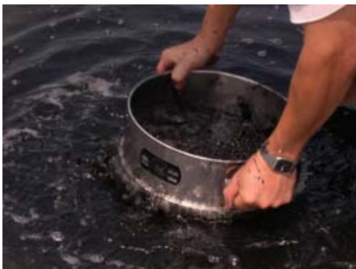
圖九、以 0.5mm 網目的不鏽鋼篩淘洗抓泥斗所取得土樣。
