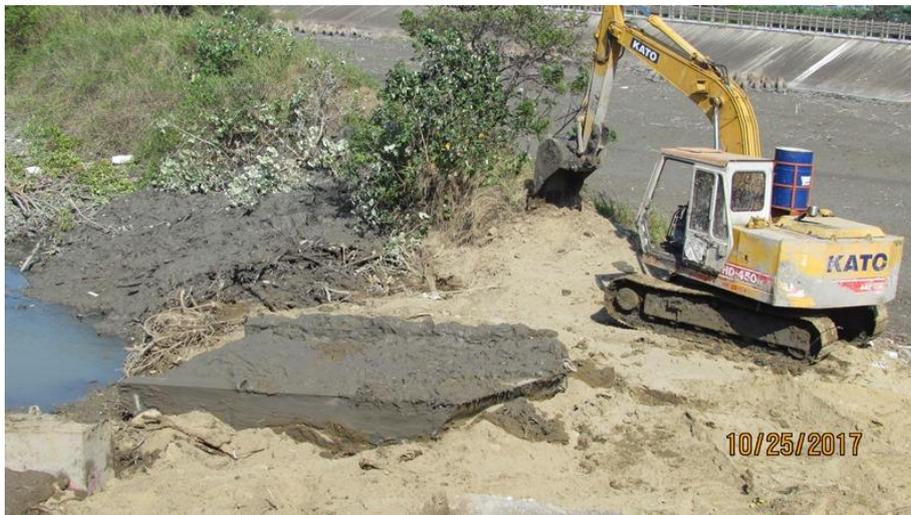
圖二十四：浮筏怪手陷入被拉起狀況
