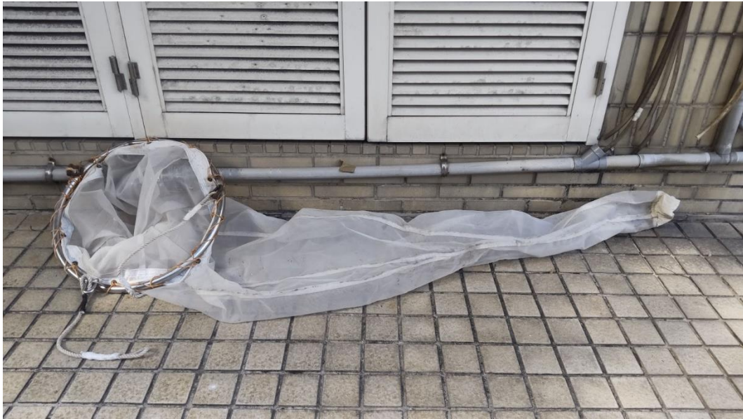
圖 13、本計畫採集蟹類大眼幼體所使用的浮游動物網。
